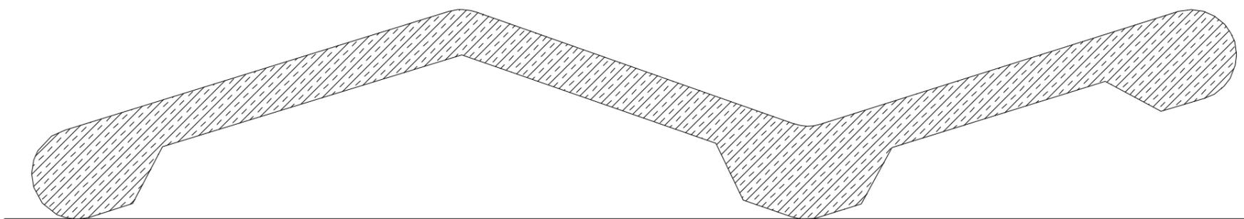
Plattenstärke 90mm/180mm, Armierung DN 6mm,
